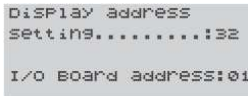
Рисунок_3.3 – Экран настройки адреса pLAN
